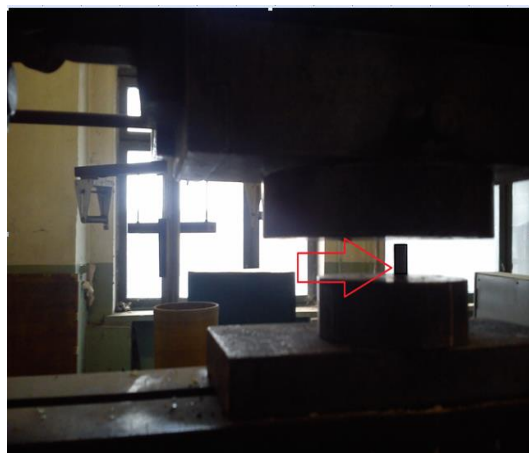
Рис.5. Видяд дослідної ділянки прецизійної прес-машини L.Shopper, із встановленим перед тестуванням зразком
