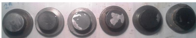
Рис.1. Вигляд сталевих циліндрів для досліджень, з плівками адгезивів після тестів на розрив
