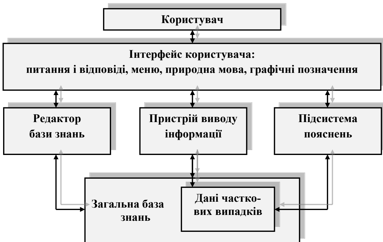
Рис. 6.2. Архітектура типової експертної системи
